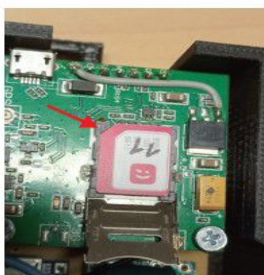
Colocar Sim con muesca hacia arriba y a la izquierda.
